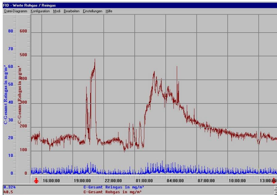
Abb. 10: TOC-Konzentrationsverlauf Rohgas / Reingas vom 17.3.2000 der Trockenstabilisat®-Anlage Rennerod
