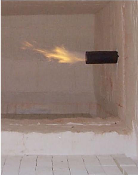
Abb. 8: Blick in die Brennkammer der Abgasbehandlung mit Erdgaszuführung
