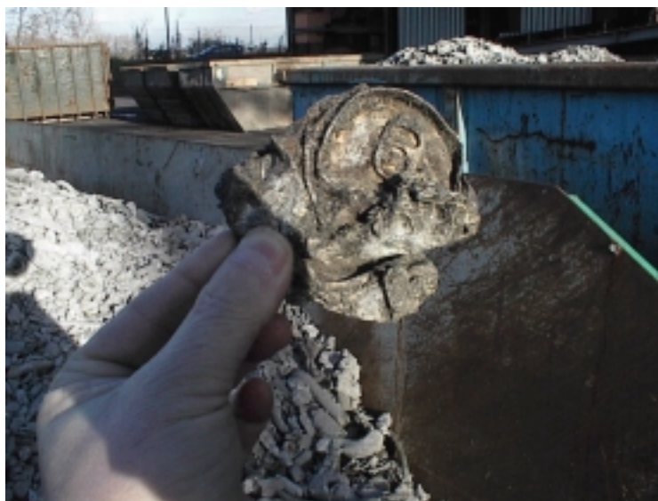
Abbildung 14: Abgetrennte NE-Fraktion bei der STRABAG (MV-Schlacke-Aufbereitung)
