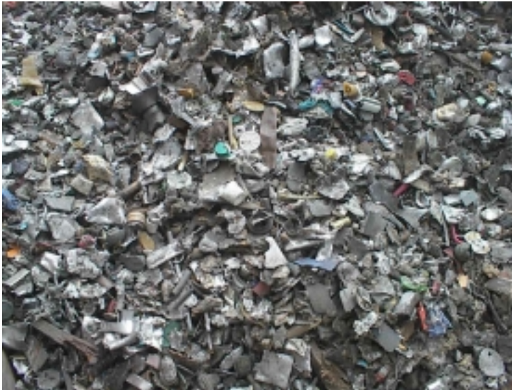
Abbildung 12: MBA Aßlar (Stabilat-Anlage): Abgetrennte NE-Fraktion
