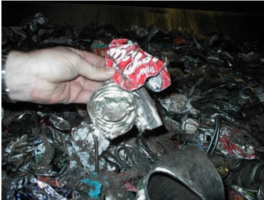
Abbildung 10: MBA Kaiserslautern (Splitting-Anlage): Fe-Fraktion aus Grobfraktion
