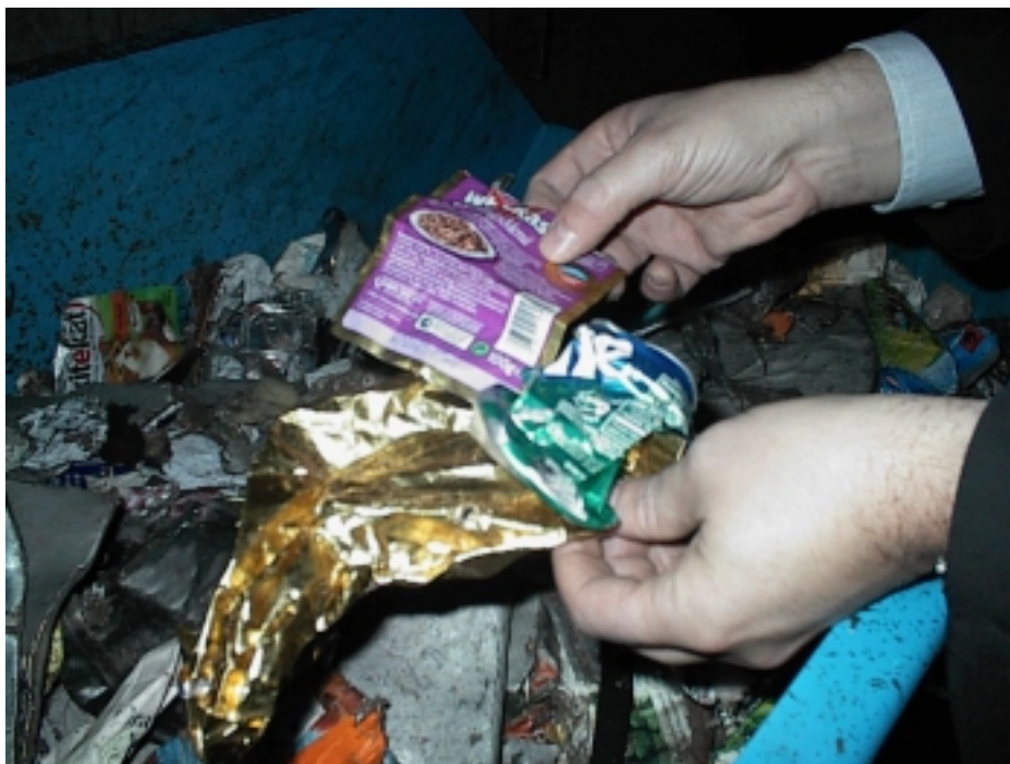
Abbildung 11: MBA Kaiserslautern (Splitting-Anlage): NE-Fraktion aus Grobfraktion
