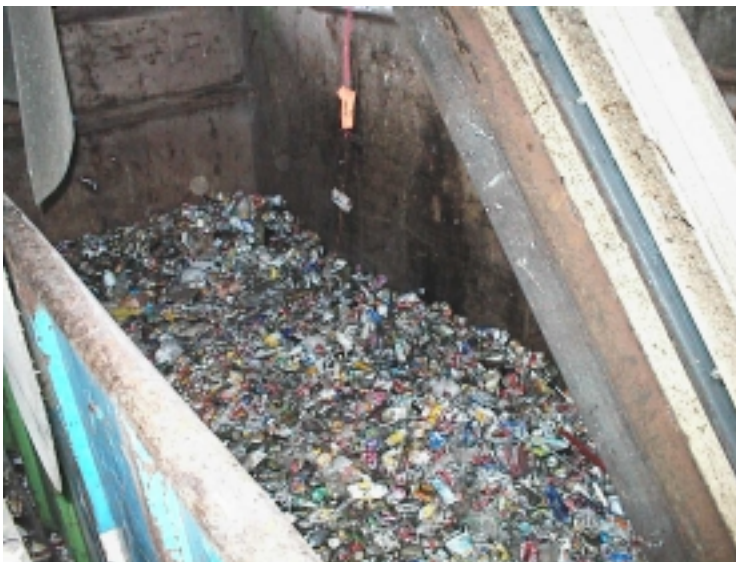
Abbildung 13: Fa. Trienekens, Anlage VZEK: Abgetrennte NE-Fraktion aus der Aufbereitung der LVP-Fraktion
