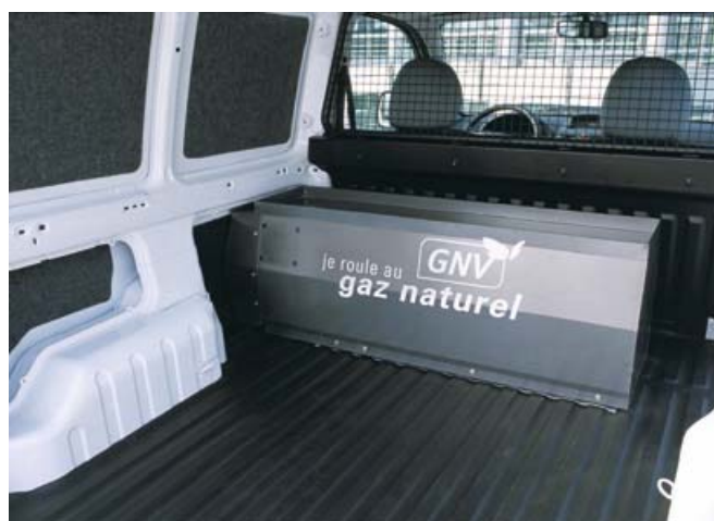
Bild 3: Platzierung Erdgastanks im Erdgas Peugeot Partner 190 C 1.4 Erdgas [42]
